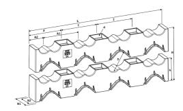
Esfuerzo de torsión inicial: 5 – 8 Nm. (dependiendo de las especificaciones del fabricante del cable).
